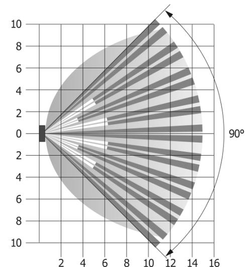
Area di rilevazione: ■ Infrarosso ■ Microonda
