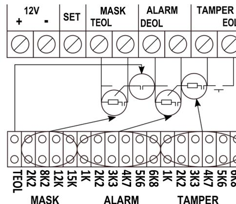
**NB: Lasciando i ponticelli aperti come da fabbrica, DtSPOT rimarrà configurato come un qualsiasi sensore con contatti NC.**
