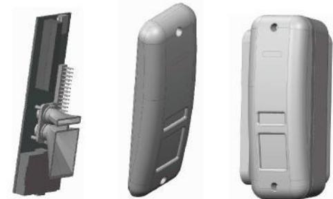
L'altezza di installazione ideale è di 2.50 m, con una portata di rilevazione di 12 x 2.7 m, variando l'altezza di installazione la portata di rilevazione diminuisce proporzionalmente. Installare il sensore in modo che non ci siano nelle sue vicinanze oggetti in movimento o che potrebbero muoversi con il vento come alberi o piante.
